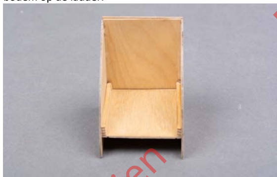
Afbeelding: bodem vastgelijmd
