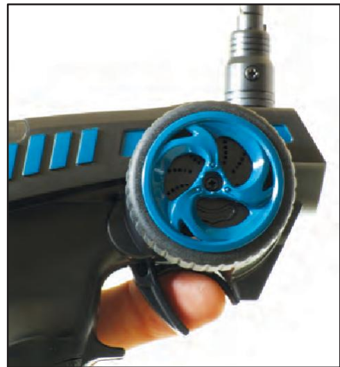
Als je het model wegduwt, moet het remmen (en dan achteruit rijden als dat van toepassing is). Als dat niet het geval is, zet je de gashendel gewoon in de stand 'Toeren'.
