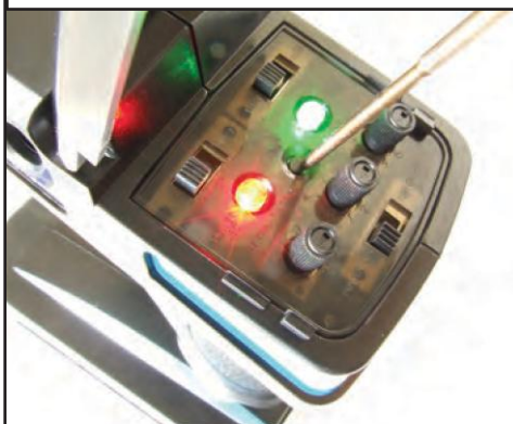
Als de stroom is ingeschakeld, kun je de bindknop loslaten zodra de groene LED begint te knipperen om aan te geven dat het "Bind"-proces is gestart.
