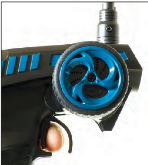
Als je de gashendel terugtrekt naar de handset, moet het model naar voren bewegen. Als dat niet het geval is, zet je de gashendel in de stand 'Toeren'.
