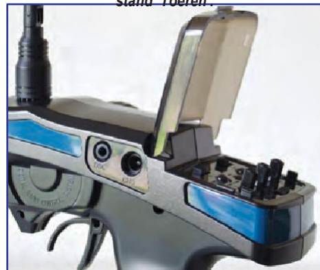
Als je de gashendel terugtrekt naar de handset, moet het model naar voren bewegen. Als dat niet het geval is, zet je de gashendel in de stand 'Toeren'.
